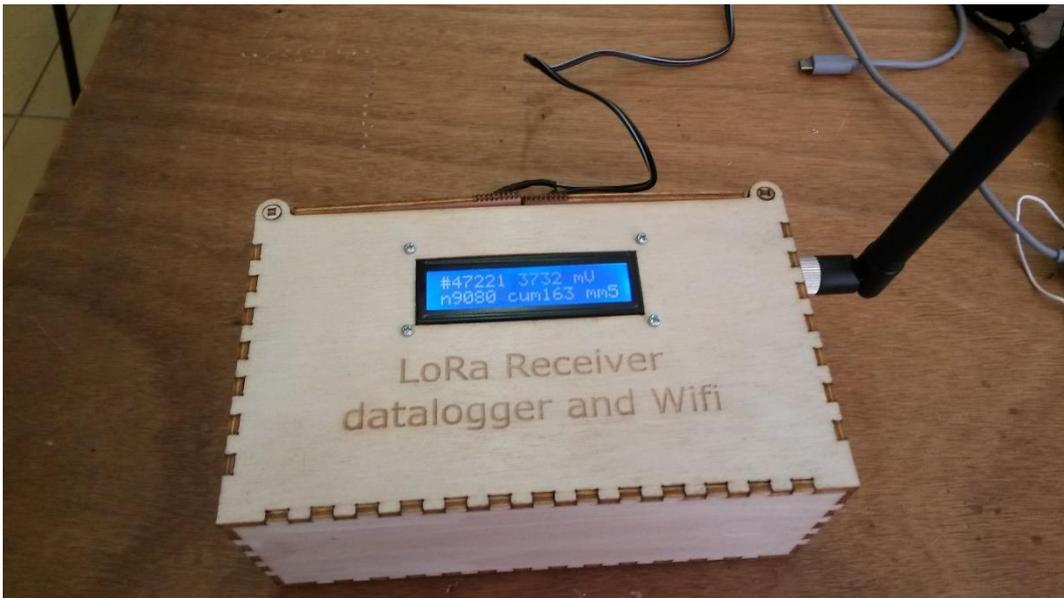
La stazione di ricezione ha lo scopo di ricevere i pacchetti di dati inviati dal pluviometro e di passarli, sia al data-logger per la loro registrazione con la data e l'ora su card SD, sia alla scheda ESP8266 che provvede ad inviarli, tramite una rete WiFi disponibile, al server prescelto. Nel caso in cui non si disponga di una rete WiFi, questa scheda può essere omessa. La stazione è dotata anche di un display LCD retroilluminato per la visualizzazione dei dati in locale.
