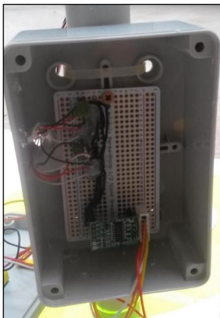
La scatola contiene nel coperchio, la batteria, la scheda Adafruit (vedi paragrafo dell'elettronica) e il connettore per l'antenna. Nel corpo è contenuta una millefori con i collegamenti tra le celle e il chip amplificatore. I collegamenti tra corpo della scatola e coperchio sono assicurati da due connettori JST.
