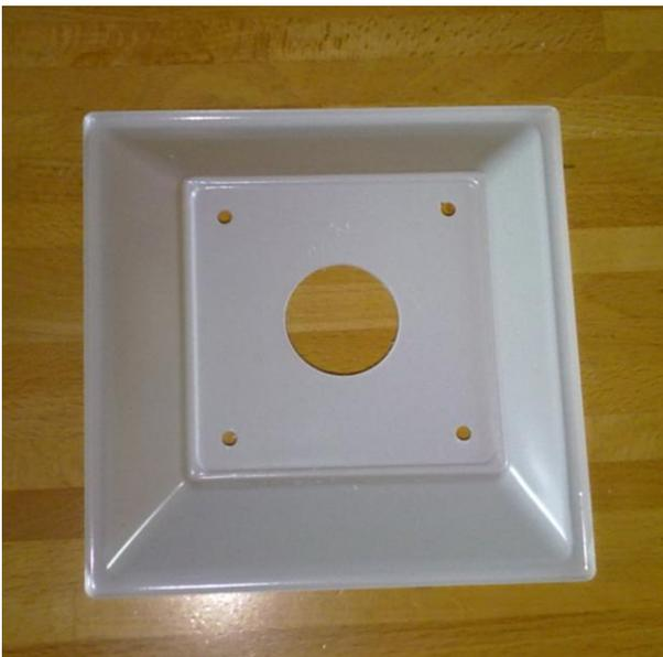
Si incomincia con la foratura della "risma" di piatti (io ne ho usati 6), facendo 4 buchi da 5 mm per le viti di sostegno e un buco centrale da circa 30 mm che servirà a introdurre i sensori. Quest'ultimo può essere ottenuto usando una sega a tazza e un trapano a colonna. Attenzione alla velocità del trapano, perché la plastica può lacerarsi facilmente.
